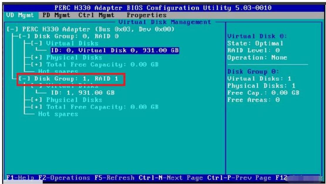
5、初始化 VD,将光标移动到 ID:1 前面按下 F2,——>initialization——>fast init
