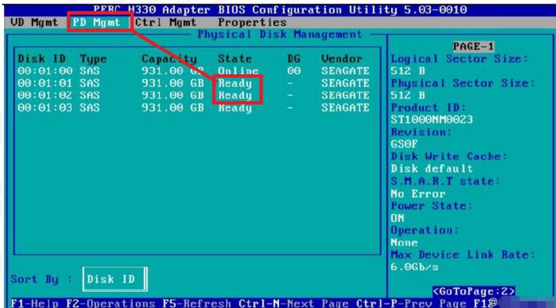
2、按 ctrl+p 回到 VDMgmt 界面, 选中 PERC H330 Adapter (Bus 0x03 ,Dev 0x0) ,并按下 F2, 选择 Create New VD,进行创建阵列, 如下图。
